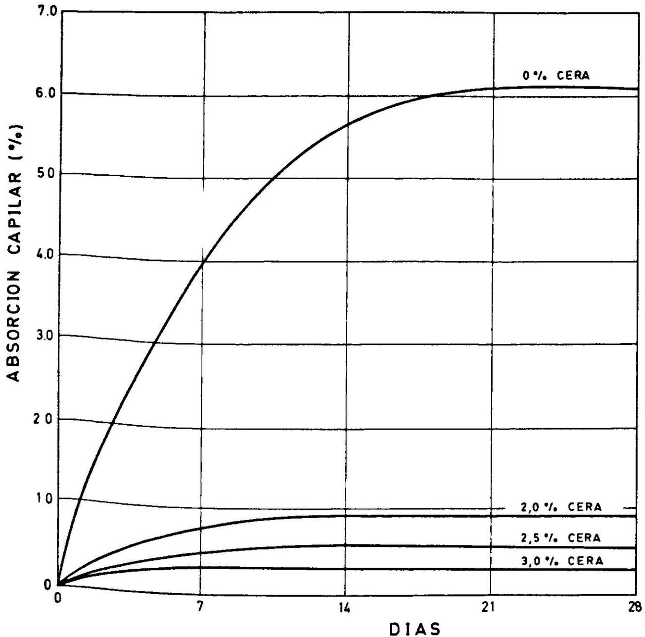
Fig. 2. Absorción capilar de las probetas de mortero.
