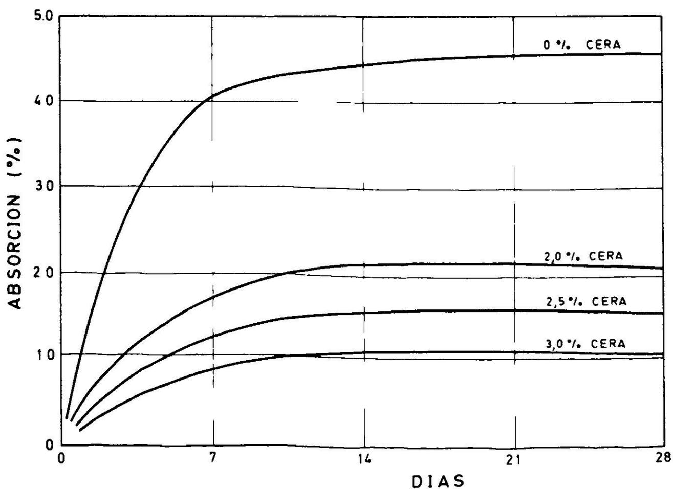
Fig. 1. Absorción de las probetas de mortero en función del tiempo.
